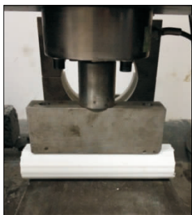
图2 UPVC 声测管环刚度试验
