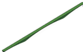
图 2 主梁有限元模型
