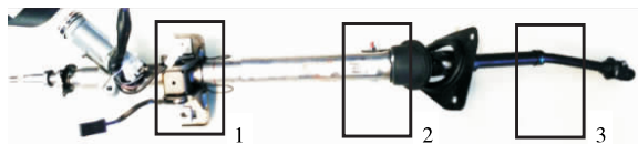
图 2 碰撞后的转向管柱及转向中间轴样件
