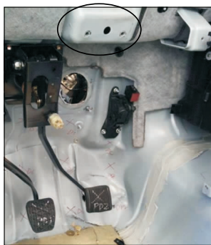
圈内为转向管柱下安装处。
