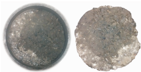
图4 振动时间过长导致的试件上部结构被振碎的情况
