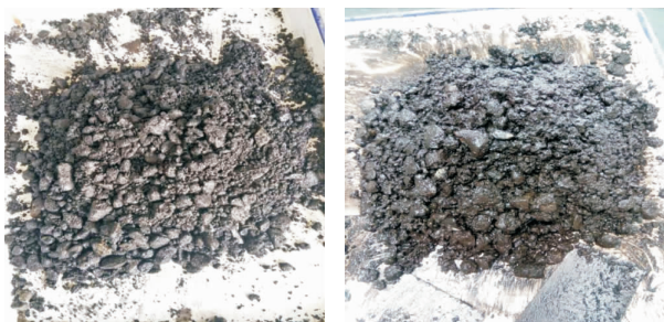
(a) 旋转压实法含水量下拌和料 (b) 和易性最优含水量下拌和料
