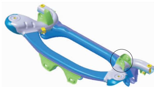
图15 优化上摆臂到副车架安装点实现悬架系统刚度优化
