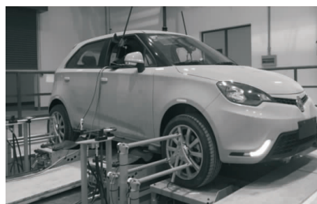
图 12 KC 试验台架
