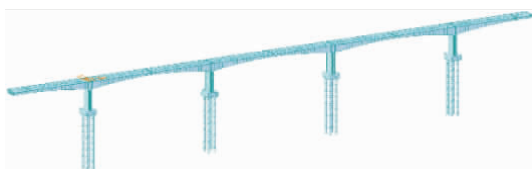
图 16 张公庙大桥地震分析模型
