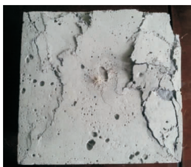
图9 砼试验破坏形态
