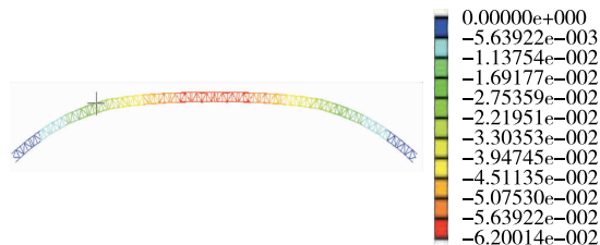
图4 拱架位移等值线图(单位:m)
