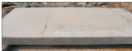
图 6 板厚 18 cm 试验检测模型
