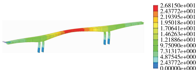
图 4 地震反应谱作用下钢腹板 PC 连续梁桥的变形(单位:mm)
