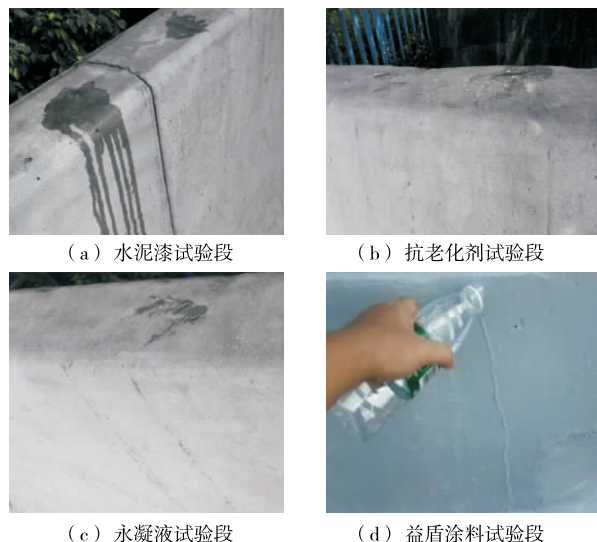
图 4 砼护栏渗水试验结果
