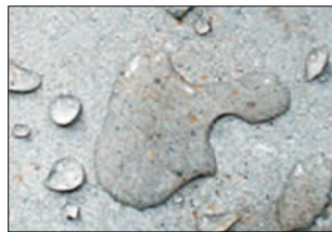
图2 水泥路桥抗老化剂的防水效果
