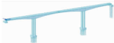
图 2 桥梁有限元模型
