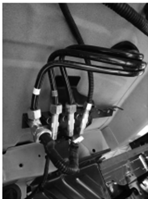
图2 手制动阀驾驶室外管路接口示例
