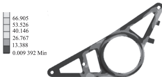
图 13 优化后差速器支撑架的主应力分布(单位: MPa)
