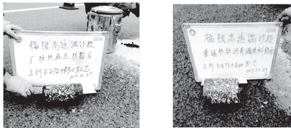
图 1 福银高速公路温沙段现场钻取的芯样
