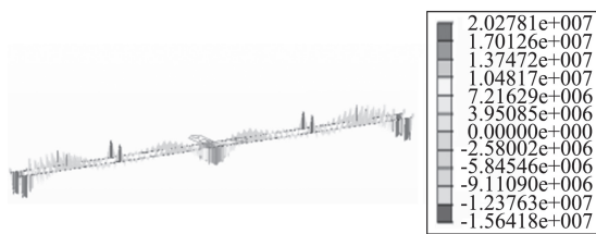
图3 成桥状态下钢梁弯矩(单位: N·m)
