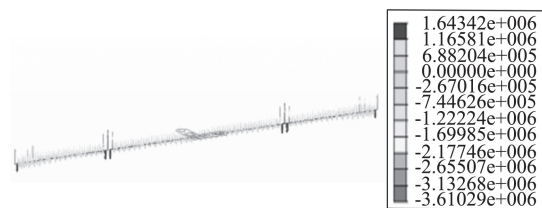
图4 成桥状态下桥面板弯矩(单位: N·m)
