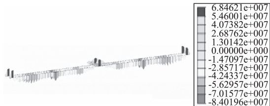
图 1 成桥状态下钢梁应力(单位:Pa)
