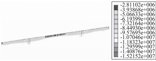
图 2 成桥状态下桥面板应力(单位:Pa)
