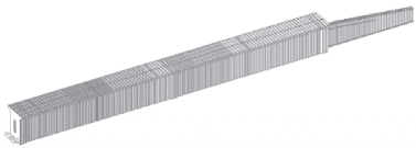
图 3 连续箱梁顶推施工仿真计算模型
