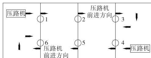
图3 堆载填土层压实度检测断面布置
