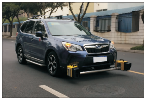
图 1 车载式道路交通标线逆反射测量仪
