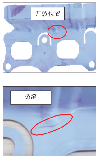
图 2 排气歧管垫片耐久试验后出现的裂纹
