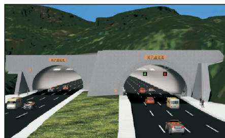
图3 添加地形的隧道 BIM 模型
