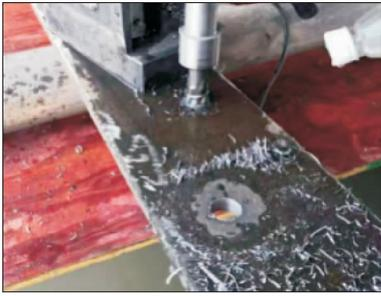
图8 钢板条打钻孔处理
