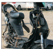
(b) 汽车-电动自行车事故中电动自行车受损情况
