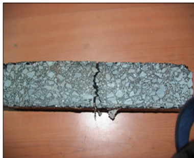
图 9 TLA 改性沥青混合料破坏试件
