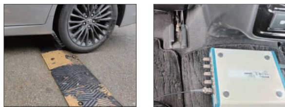
图4 车辆通过减速带时垂直加速度的测量
