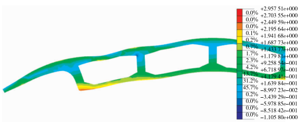
图9 对称车道荷载工况下箱梁截面主应力及变形 (主应力单位:MPa)
