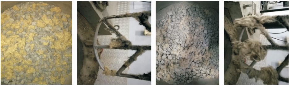
图 1 AC-13 沥青混合料中高模高强 PAN 纤维的分散情况
