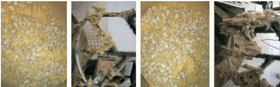
图 2 SMA-13 沥青混合料中高模高强 PAN 纤维的分散情况
