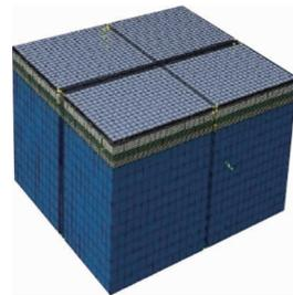
图1 粗粒式应力吸收层有限元分析模型
