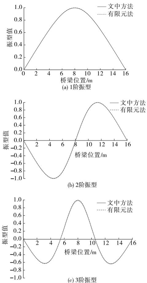
图 9 拱形简支梁的前 3 阶振型
