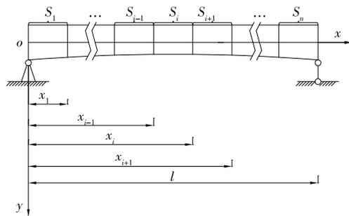
图 1 变截面简支梁求解模型
