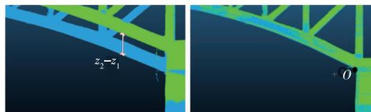
图 11 点云  $Z$  方向整体对齐及坐标原点确定
