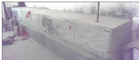
图 1 隧道二次衬砌模型
