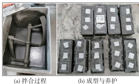
图1 磷石膏基灌浆材料试件的制备
