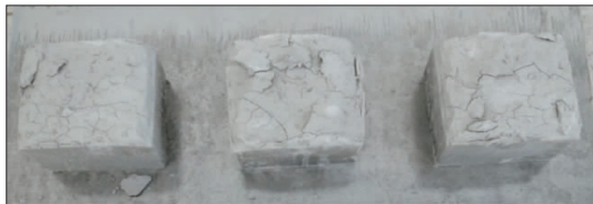
图5 磷石膏基灌浆材料试件浸泡60 d时形态
