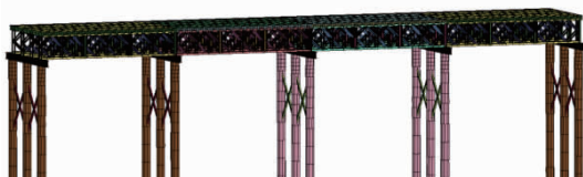
图 8 四跨钢栈桥模型
