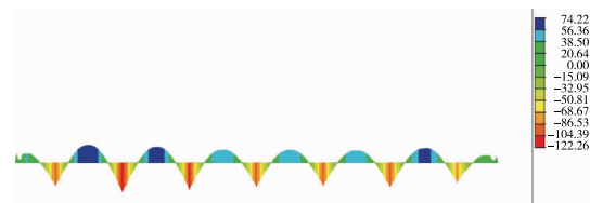
图 8 采用双向对称铺装法施工时成桥阶段钢箱梁应力云图(单位:MPa)
