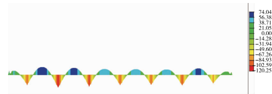
图 7 采用单向连续铺装法施工时成桥阶段钢箱梁应力云图(单位:MPa)
