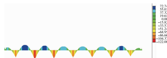
图 9 采用墩顶对称铺装法施工时成桥阶段钢箱梁应力云图(单位:MPa)
