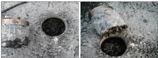
图7 破坏面位于沥青层内
