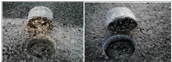
图6 破坏面位于水泥混凝土基面交界面处
