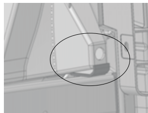
图 7 前保险杠防下沉支撑结构
