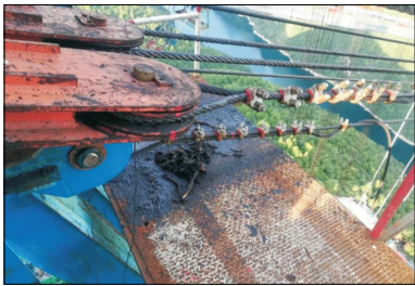
图 5 安装好的销轴传感器
