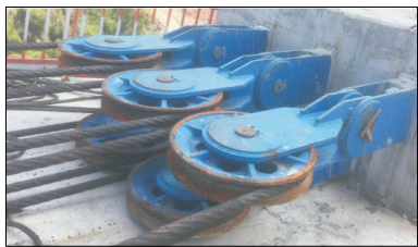
图2 平衡轮示意图
