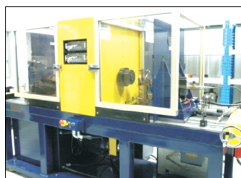
图 1 制动拖滞试验台架
