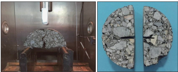
图 3 半圆弯曲试验
