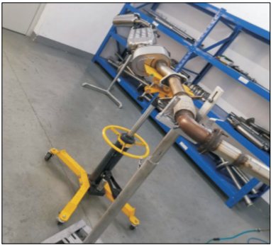
图 14 排气系统冷流背压试验台架
