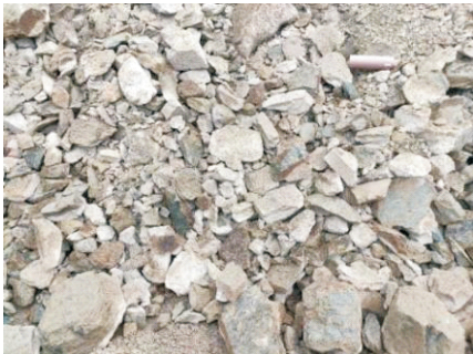
图 4 V 级岩体爆破碎片现场图片
