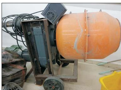
图 2 模拟混凝土搅拌运输车的试验设备
