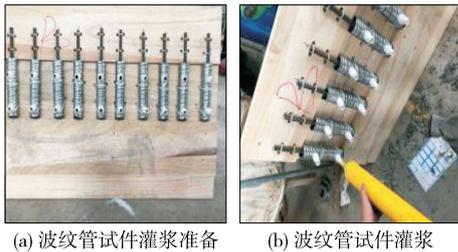
图 1 波纹管试件制作
