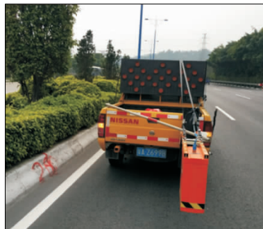
图 2 SIR-30E 型地质雷达采集系统
