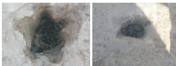
图3 预应力砼桥梁孔道压浆现场钻孔验证
