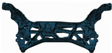
图 5 前副车架的 CAE 模型
