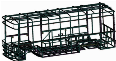
图 3 车身骨架有限元模型
