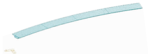
图 4 曲线箱梁桥梁格模型
