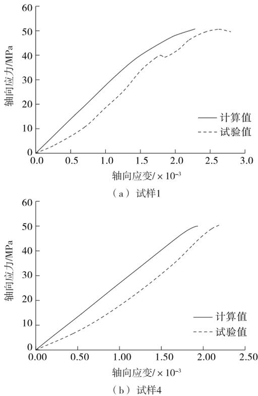
图7 轴向应力应变拟合曲线对比
