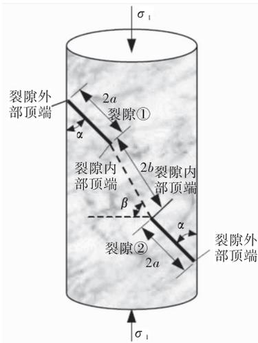
图3 断裂预制裂隙几何分布
