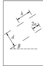
图2 非贯通裂隙示意图
